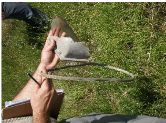
Vestigios de artefacto de alumbrado público caído que encontró el equipo auditor a la entrada del Barrio San Ramón.
