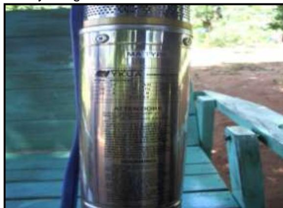
Electro bomba sumergible sin uso por ser trifásico.
