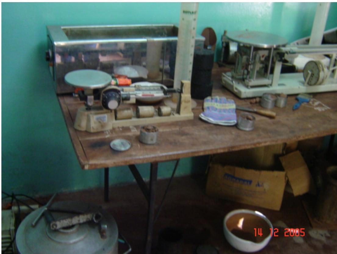
**FOTO N° 6:** Equipos de laboratorio de suelos pertenecientes a la Consultora. Los ensayos en gral se efectúan diariamente en el laboratorio del contratista (Campamento Km 6)
