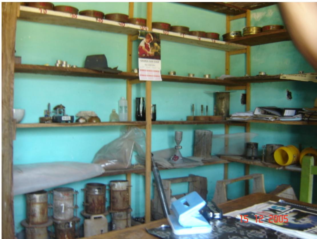
**Foto N° 9:** Puerto Antequera – Equipos de laboratorio de suelo del Contratista Consorcio San Pedro, en una pieza alquilada, donde se efectúan los ensayos con participación del laboratorista de la Consultora, cuyos nombres no figuran en listado presentado en certificados. La Fiscalización no tiene equipos ni laboratorio propio.
