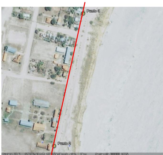
Vista aérea del sitio de obras, puntos UTM con inicio en 2 y finalización en 3, totalizando 370 metros lineales de empedrado construido.
