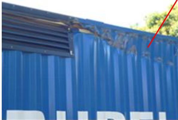
Abolladura y corte de la pared lateral del contenedor lado motor
