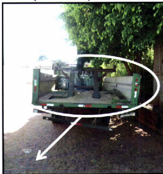
Camiones de la ANDE que transportan transformadores averiados, tienen como única protección contra derrames de aceite una capa de arena colocada en la carrocería del camión, lo cual es insuficiente para prevenir su derrame y contaminación del ambiente Fuente: Contraloría General de la República
