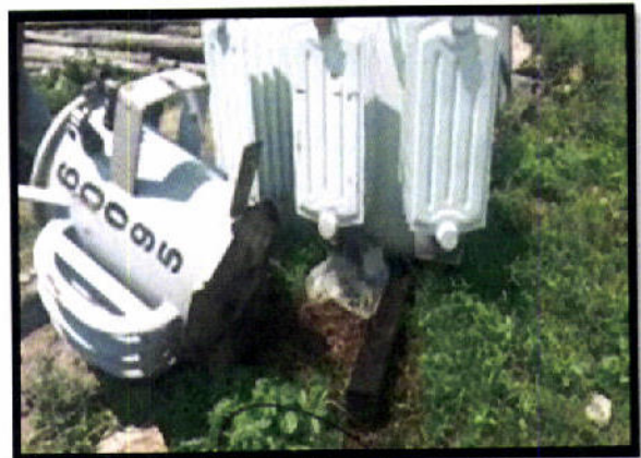
Equipos averiados a la intemperie, situados frente al depósito de Fuerte Olimpo y otros con derrame de aceite, cercano a un curso de agua
