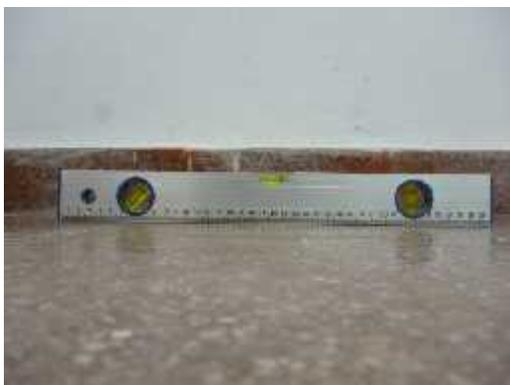
Piso desnivelado, medido con nivel de burbuja.
