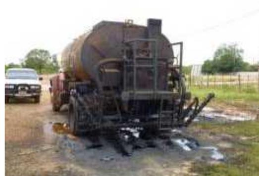
Único regador de asfalto p/el tramo, presenta frecuentes pérdidas de material asfáltico.
